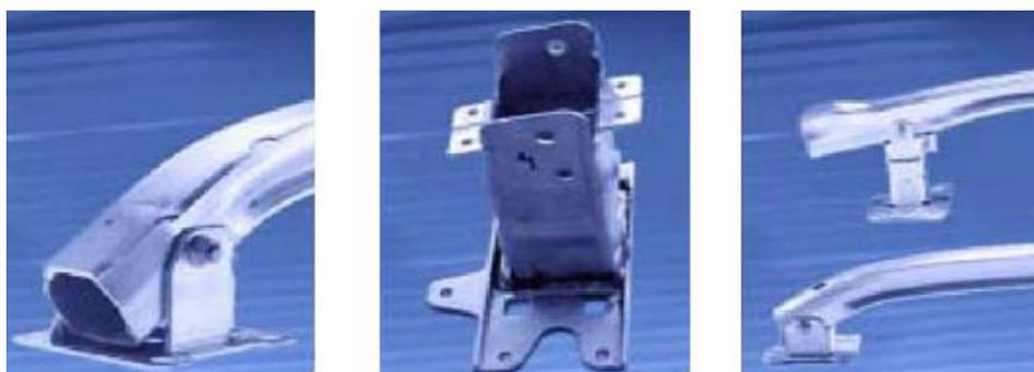
Figura 03- Componentes de colisão da estrutura frontal e dos para choques do golf-VFonte: [9]
