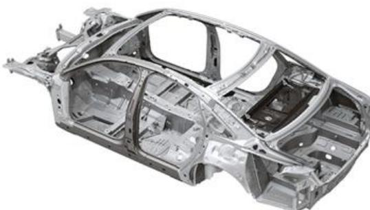
Figura02 – Carroceria Audi A8 Body in White Fonte: [11]
